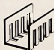
koellichaam voor T0-220 en dergelijke plastic transistorbehuizing R_{HS-A} = 102 \text{ } ^\circ\text{C/W}
